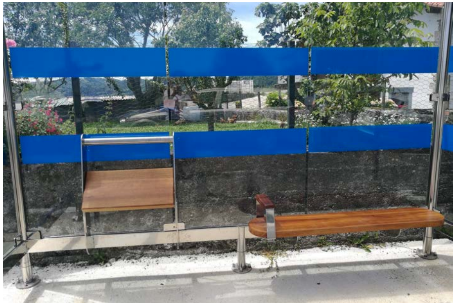
Tolosako Urkizu auzoko autobus geralekuko eserlekuak: iskiatikoa eta arrunta. Eserlekuak zurezkoak izateak erosotasuna areagotzen du.
