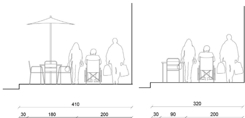
Baimenak ematerakoan, Udalak irisgarritasunari dagozkion gutxieneko dimentsioak zaintzeaz gain, erabiltzaileek planuan aurreikusitakoa baino espazio gehiago hartzen dutela kontuan izan beharko luke.
