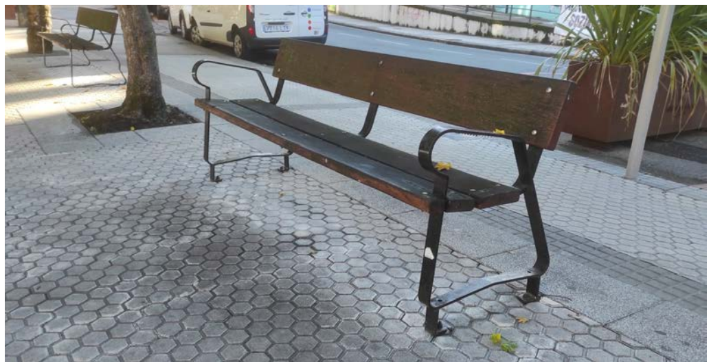
Errazago eseri eta jeikitzeo, eserleku irisgarrien bi albo banatan heldulekuak jartzea eskatzen du araudiak. Horretaz gain, 40-45cm-tako altuera ezartzen du araudiak: normalena da adinekoek 45cm edo gehiagoko altuera eskatzea.
